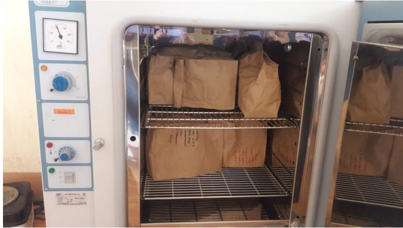
Foto 6. Secado de muestras en el horno del laboratorio Estación Experimental
