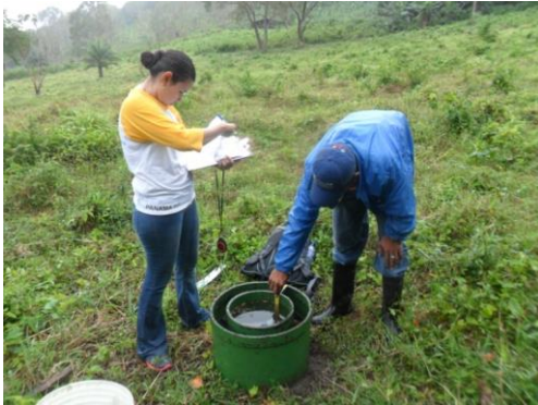
Foto 12. Prueba de infiltración mediante método de doble anillo.
