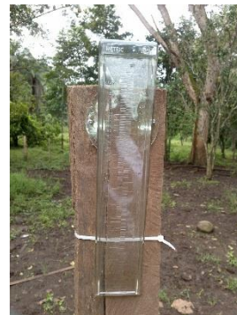
Foto 7. Pluviómetro instalado en la Comunidad El Refugio.
