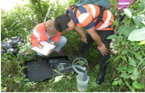
Foto 3. Medición de parámetros de campo en pozo PE-2.
