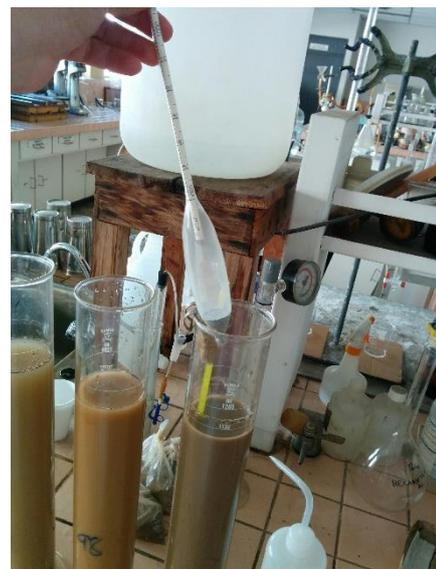
*Anexo 1. 6. Medición con Hidrómetro, prueba de Bouyoucos*
