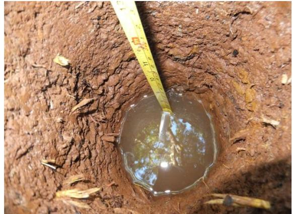
Anexo 1. 1. Prueba de infiltración por el método de Porchet
