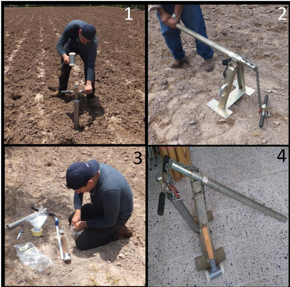
*Anexo 1. 12. Extracción de muestras para análisis de cesio 137. 1) Introducción del muestreador. 2) Extracción del muestreador. 3) separación y codificación de las muestras. 4) Instrumentos.*
