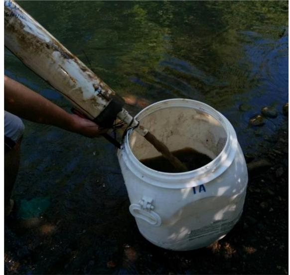
*Anexo 1. 11. Recuperación y vaciado de trampas de sedimento.*
