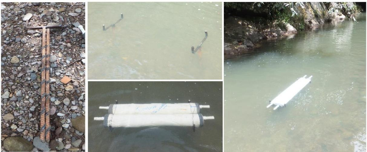
*Anexo 1. 10. Instalación de trampas de sedimento con durmientes tipo T*
