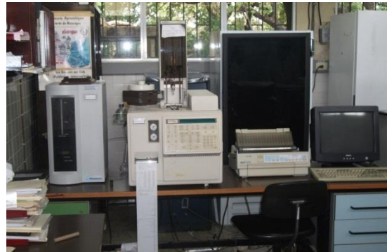
Foto 3. Cromatógrafos de gases (Varian 3400-GC) utilizado para la detección de plaguicidas organoclorados, hidrocarburos policíclicos aromáticos y Espectrómetro de Absorción Atómica utilizado para la detección de metales pesados en muestras de agua, sedimento y tejido de peces y ostras.
