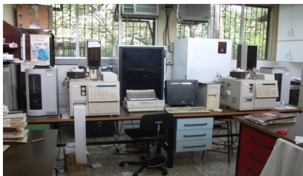
Foto 3. Cromatógrafos de gases (Varian 3400-GC) utilizado para la detección de plaguicidas organoclorados, hidrocarburos policíclicos aromáticos y Espectrómetro de Absorción Atómica utilizado para la detección de metales pesados en muestras de agua, sedimento y tejido de peces y ostras.
