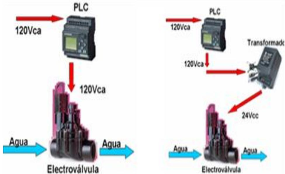
FIGURA 38. CONEXIÓN DIRECTA E INDIRECTA DE PLC-ELECTROVÁLVULA
