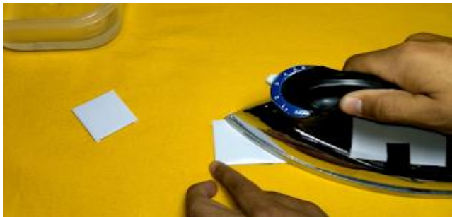
Figura 31 Planchado para transferir diseño PCB a Baquelita
