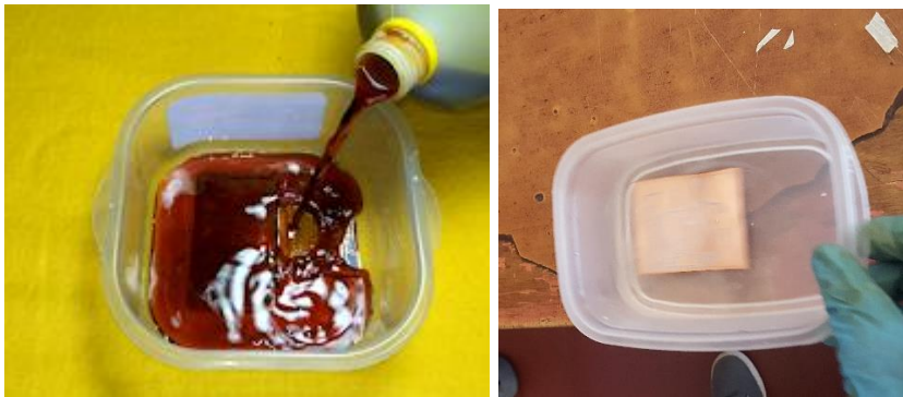
Figura 32 Ataque con ácido al PCB y limpieza del ácido
