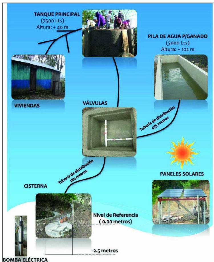
Figura 1: Diagrama del miniacueducto por bombeo solar de la comunidad El orégano, Santa Lucía, Boaco. Fuente: ASOFENIX. (2013). Manual para sistemas de agua potable a través de energías renovables.
